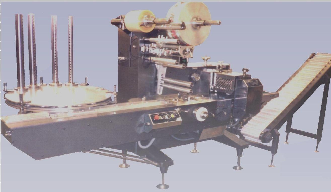
Este equipo nos permite empacar a una velocidad de hasta 350 piezas por minuto; gracias a su alimentador por gravedad y sus dos bandas de salida.
