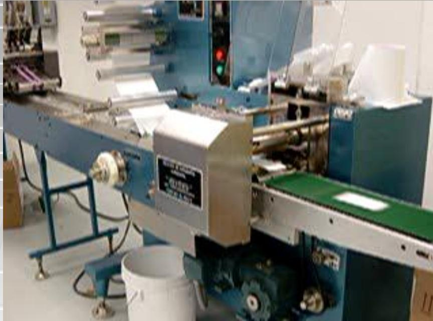
Cuenta con dos alimentadores electrónicos acoplados electrónicamente a la cadena De alimentación. Alcanza velocidades de hasta 250 paquetes por minuto.
